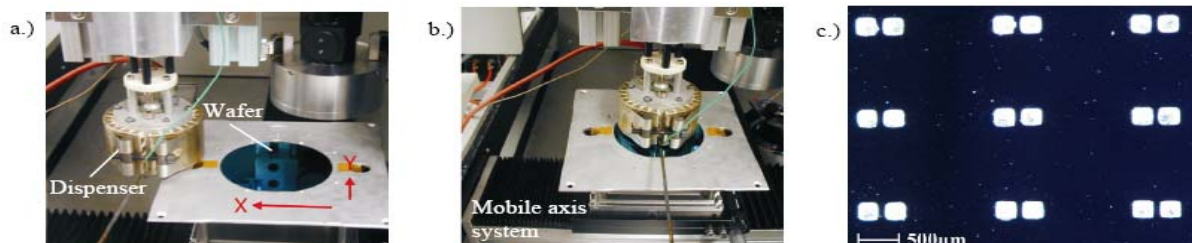
Abb. 4: Dispensierprozess mit Ergebnis auf Dummy-Substrat
