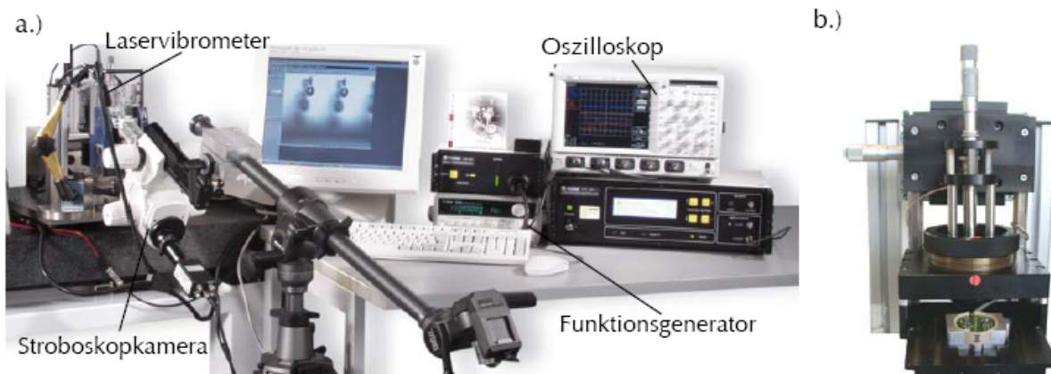
Abbildung 1 – a: Verwendeter Messaufbau zur Charakterisierung der Druckköpfe; b: Detailansicht des Print-Moduls
