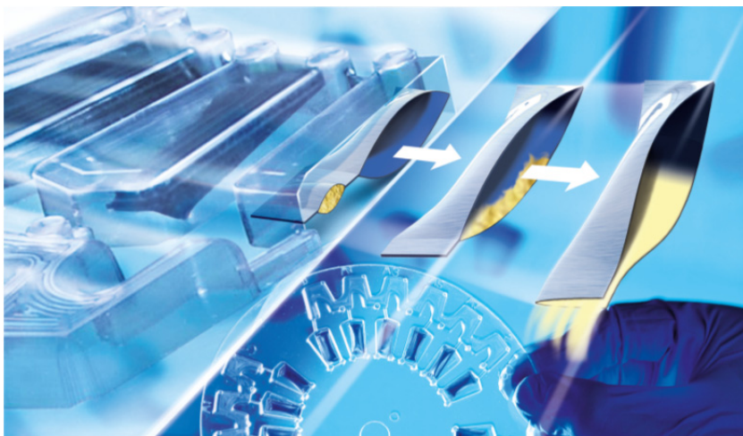
Abb. 1: Zentrifugal-mikrofluidisches Lab-on-a-Chip-System mit Stickpacks zur Reagenzienvorlagerung.
