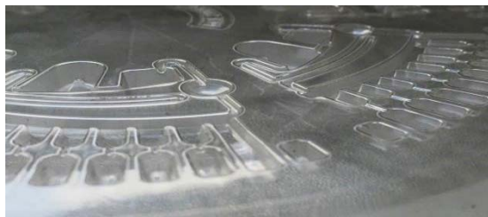
Abb. 1: Mikrothermogeformte Kunststoffolie als Ausgangspunkt zur Herstellung einer LabDisk
